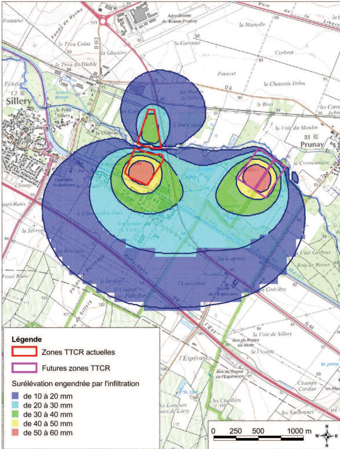
Figure 9 : Elévation piézométrique engendrée par l'infiltration des eaux condensées au mois de novembre
